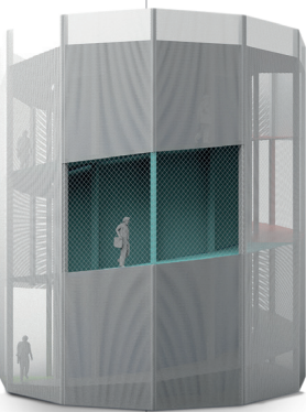
obvodový plášť: tahokov na přidavné vnější konstrukci + mezikonstrukce umožňující bezbariérový přístup na střechu
