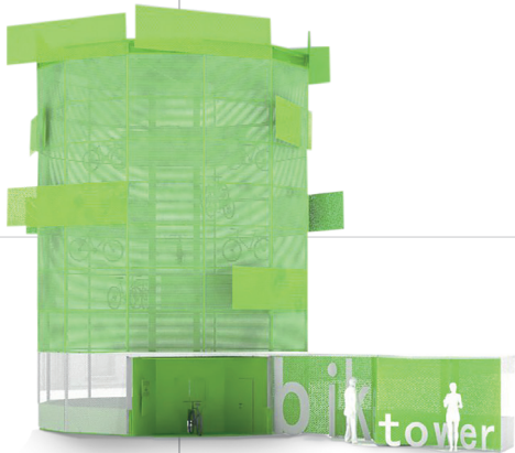
obvodový plášť: sklo + tahokov příslušenství: přidavný modul
