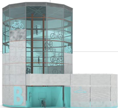
obvodový plášť: sklo + tahokov příslušenství: přidavný modul
