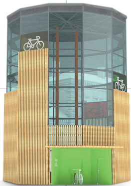
obvodový plášť: sklo + dřevěné hranoly
