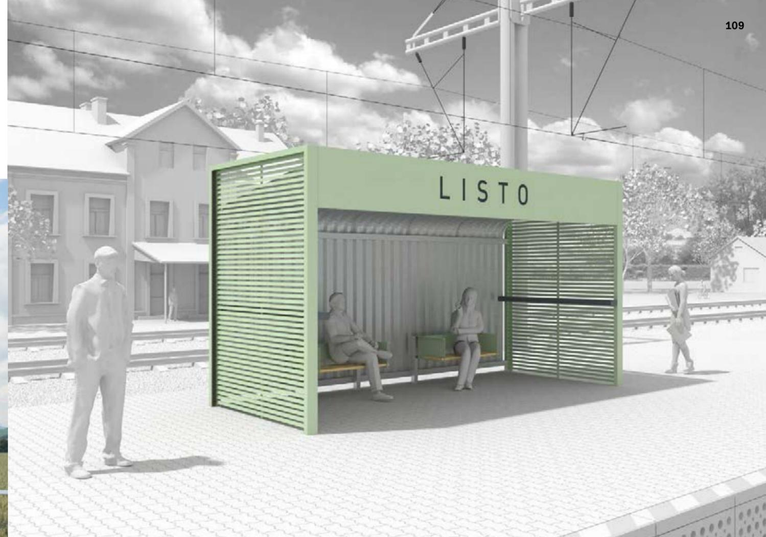
↑ Das atypische Mobiliar geht aus der Hinterwand der Konstruktion heraus. Einfache Sitzbank kombiniert geformte Blechteile mit einem Holz Sitz und dient für einen oder zwei Reisegäste.
