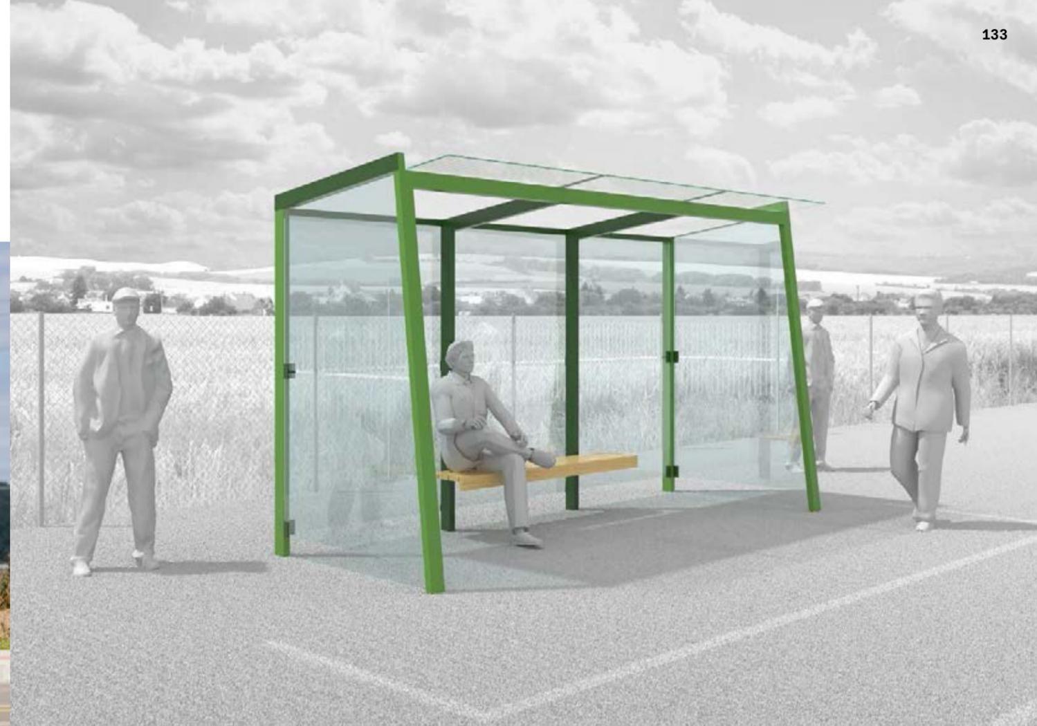
← Die Dachverglasung ist zwischen den Seitenträgern eingesetzt und wird vom vorgesetzten Profil unterstützt. Dieses Detail bildet einen visuellen Charakter von ganzer Wartehalle. Die Verglasung der Seitenwände ist als frei aufliegend durchgeführt und teils von einem Schutzprofil gestützt. Die in den Raum tretende Kante ist teilweise vom Profil geschützt, von dem das Glas hinausgetragen wird.
