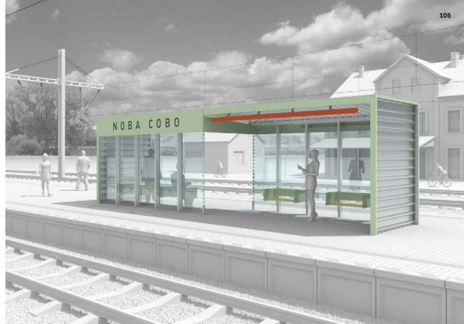
↘ Im Vorderteil ist ein markantes Linearlicht installiert, das genügend Beleuchtung für den Innenraum der Überdachung anbietet und mit seiner Farbigkeit das Dekor von umliegenden Lärmschutzwänden ergänzt.
