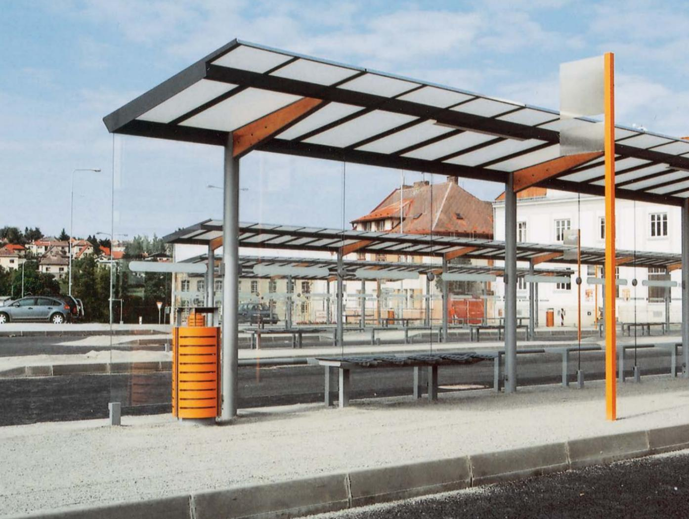
→ Als Verglasung kann man ein Milchglas oder ein bedrucktes Glas verwenden, das einen Halbschatten gestaltet. Die Transparenz trägt zu einem sicheren Gefühl von Nutzern bei und ermöglicht eine freie Aussicht in die Landschaft in der Umgebung.
