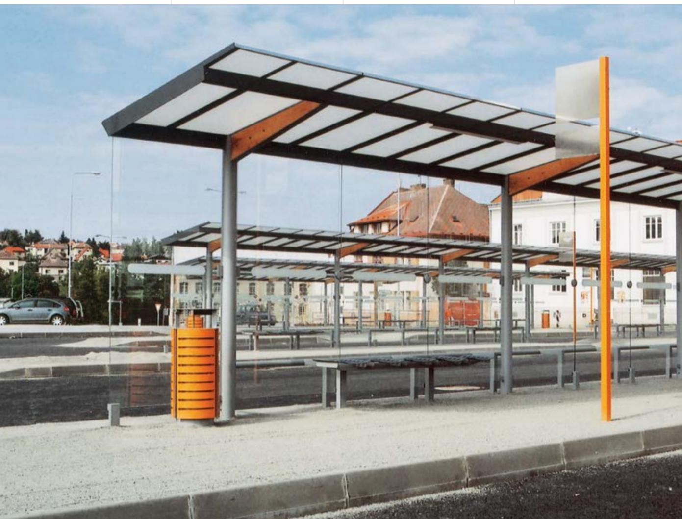
→ Als Verglasung kann man ein Milchglas oder ein bedrucktes Glas verwenden, das einen Halbschatten gestaltet. Die Transparenz trägt zu einem sicheren Gefühl von Nutzern bei und ermöglicht eine freie Aussicht in die Landschaft in der Umgebung.
